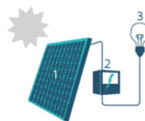
1. Zonnepaneel | 2. Omvormer | 3. Elektrische toestellen
